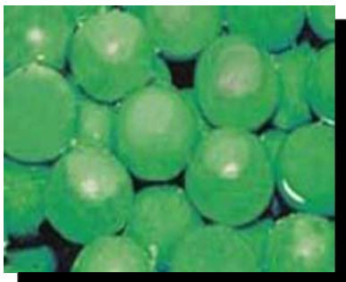
Le Powerballs sono palline di \text{NaH} ricoperte di polietilene con un diametro di 3,8 cm
