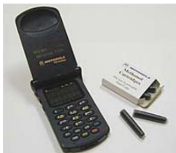
Telefono cellulare alimentato da una cella a combustibile; il "refill" è contenuto in piccole cartucce
